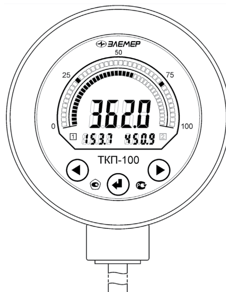
Электронный блок объединён с термопреобразователем сопротивления
