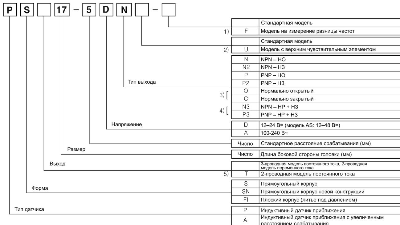
1) Исполнение на измерение разницы частот возможно только для модели PSN17.
