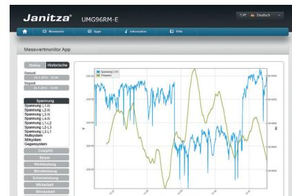
Рис.: Отображение оперативных и исторических данных через собственный Web-сервер устройства
