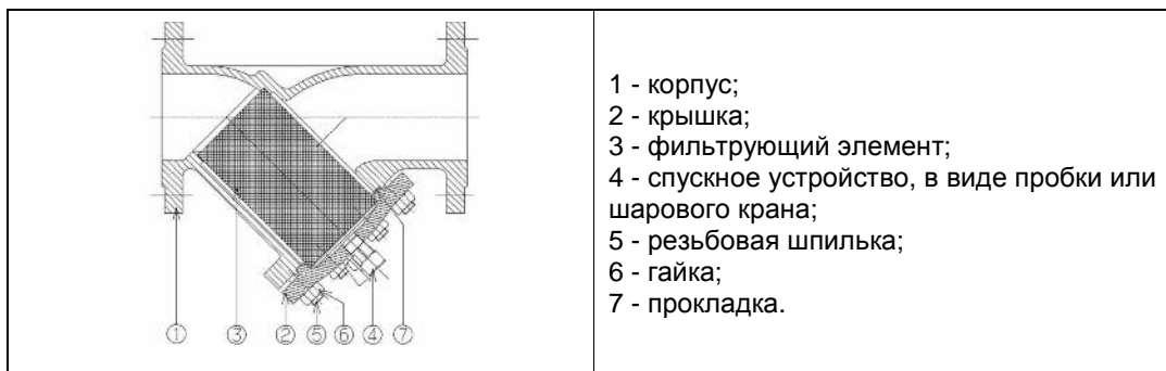
Рис. 8. Устройство фильтров сетчатых типов Y333, Y333P.
