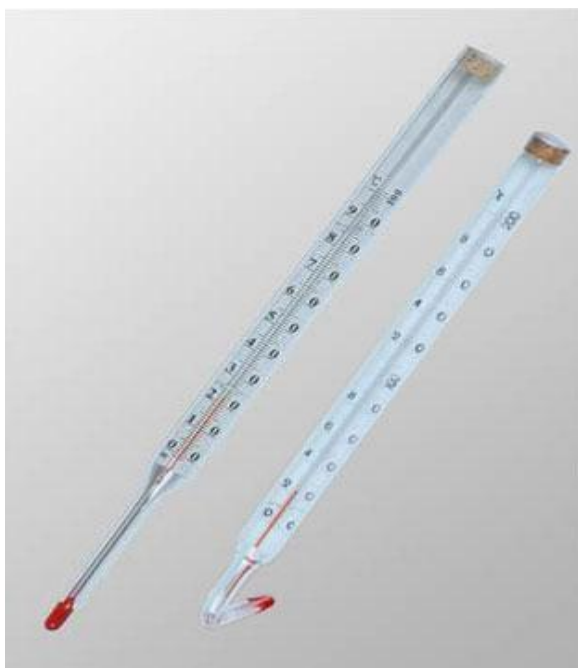
Рисунок 1 - Общий вид термометров стеклянных керосиновых СП-2
