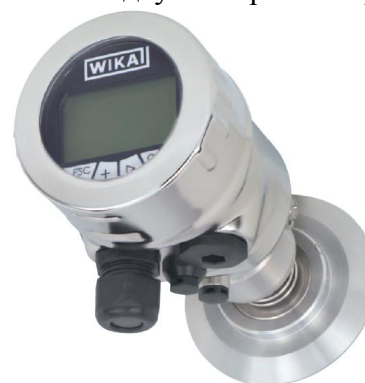
Рисунок 4 - Общий вид преобразователей давления IPT-11 (исполнение с фронтальной мембраной, стальной корпус с электрополировкой)
