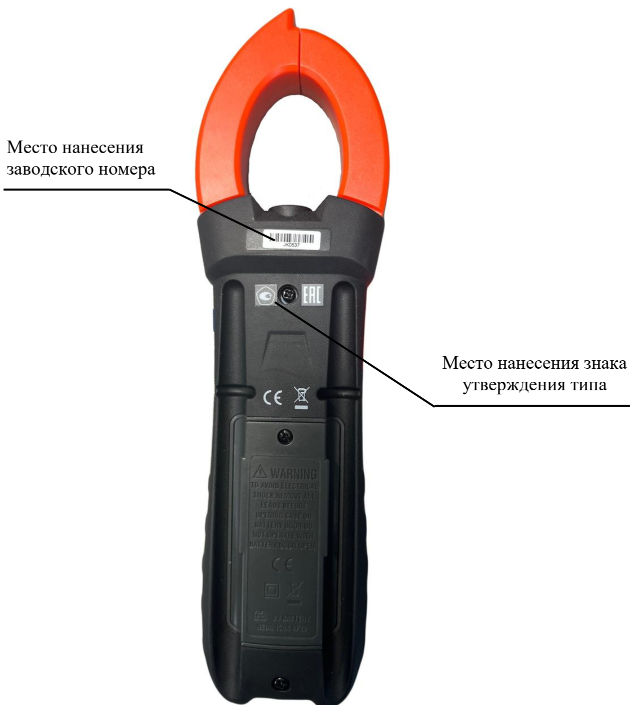
Рисунок 4 – Клещи модификации СМР-3000 с указанием места нанесения знака утверждения типа, места заводского номера
