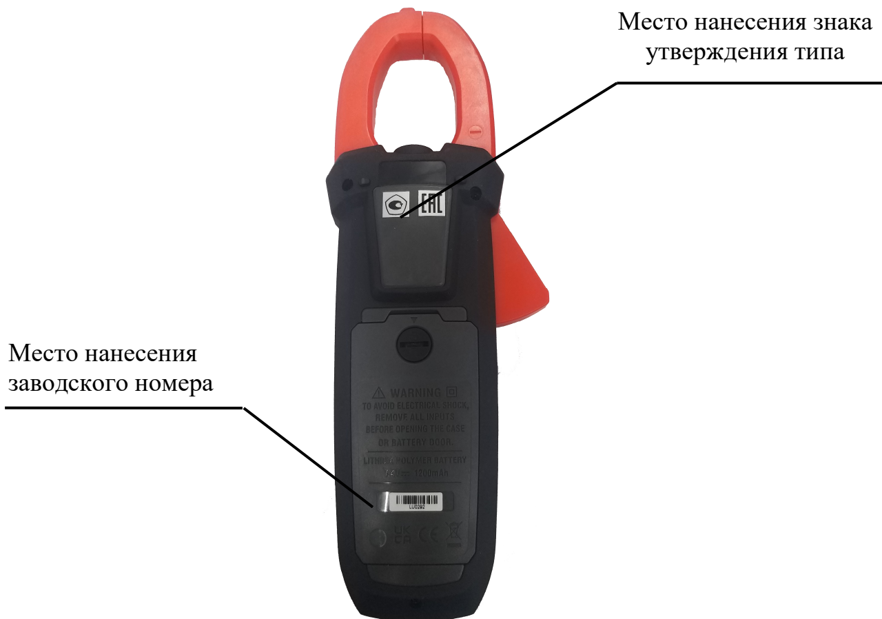
Рисунок 6 – Клещи модификации SMP-1015-PV с указанием места нанесения знака утверждения типа, места заводского номера
