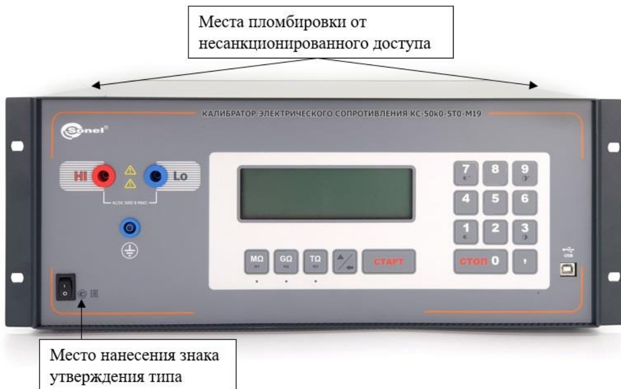
Рисунок 3 – Общий вид калибратора электрического сопротивления KC- 50k0-5T0-M19
