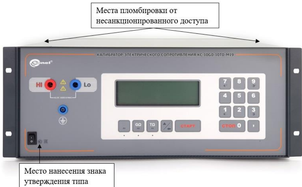
Рисунок 4 – Общий вид калибратора электрического сопротивления KC-10G0-10T0-M19
