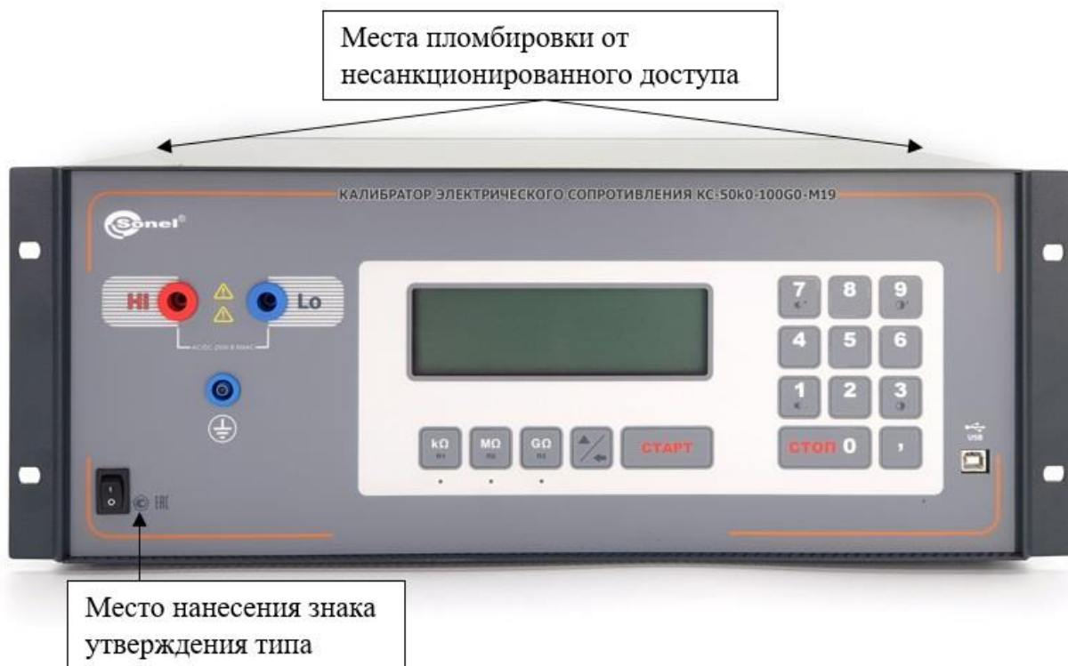
Рисунок 2 – Общий вид калибратора электрического сопротивления KC-50k0-100G0-M19
