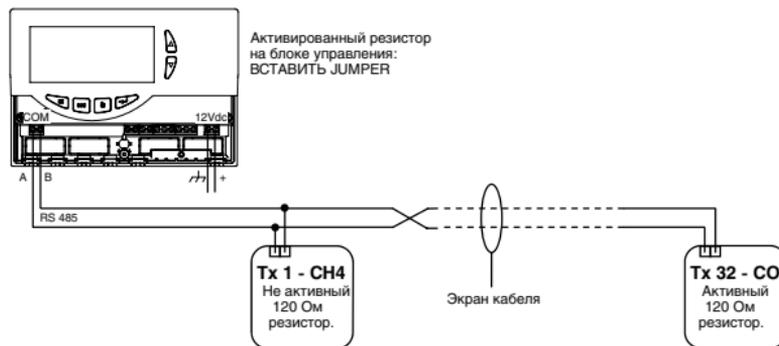
Рис. 9. Пример соединения: Блок контроля—Сенсор
