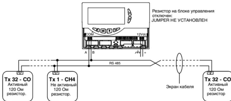
Рис. 6. Пример соединения: Сенсор—Сенсор
