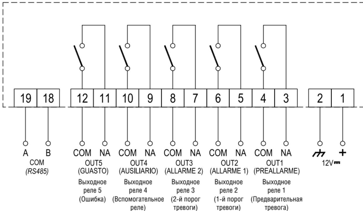
Рис. 5. Схема подключения
